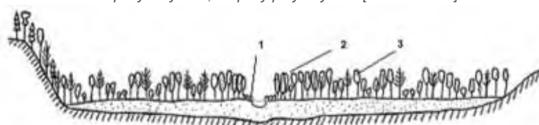
Rysunek 7. Zabudowa biologiczna dolnej części cieku przy korelacji na katastroficznie wielką wodę 1 - pasy korytowe 2 - pasy przykorytowe 3 – zalesienia [Prochal, 1968].
