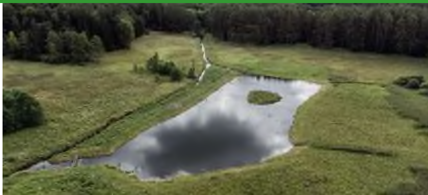
Fotografia 17. Zbiornik boczny bez piętrzenia wody w korycie ciek naturalnego w Nadleśnictwie Jastrowie, fot. J. Smarczewski, 2021.
