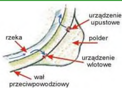
Rysunek 14. i Rysunek 15. Schematy działania polderów zalewowych [RZGW Kraków].
