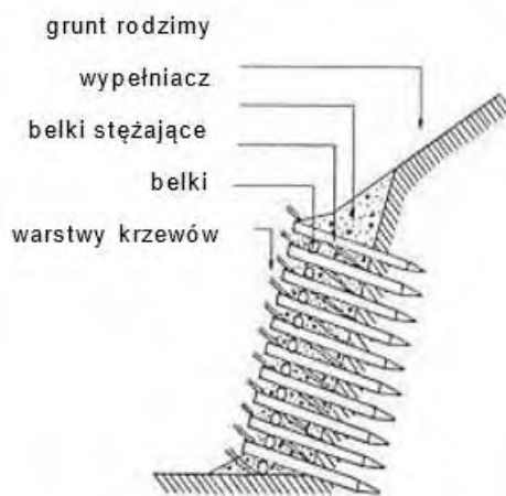
Rysunek 78. Przekrój poprzeczny kaszycy [Begemann i Schiechl 1999].
