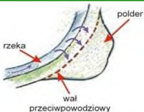
Rysunek 14. i Rysunek 15. Schematy działania polderów zalewowych [RZGW Kraków].
